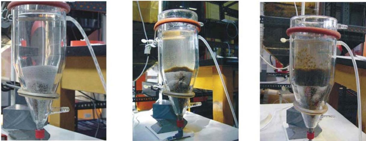
Abbildung 7.5-2: Schwebebettversuch mit 5 % Schlammzusatz und Material B3
