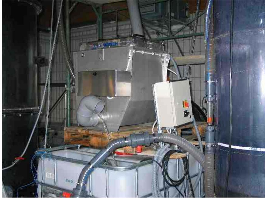
Abbildung 7.6-3: Trommelfilter der Fa. PVS, Fabrikat HYDROTECH
