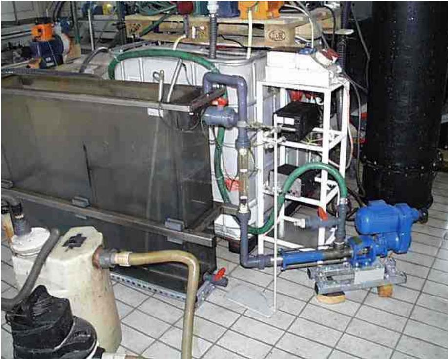
Abbildung 7.6-4: Elektroflotation der Fa. Dr. BAER
