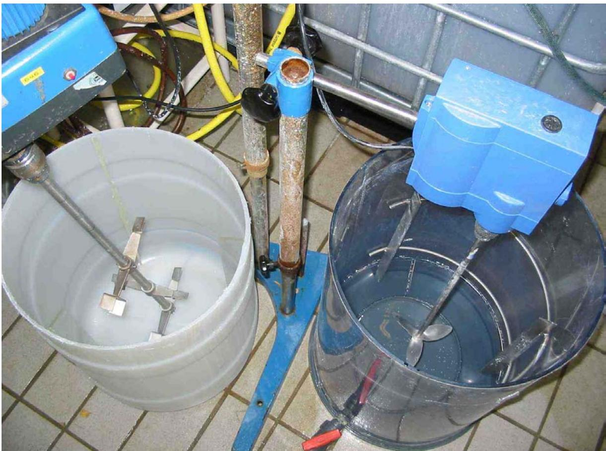
Abbildung 6.6-1: Die beiden Rührreaktoren mit Rührwerk, Rührer und Stator. Links: Rührbehälter 2 (50 L, undurchsichtig, ohne Zu- und Ablaufvorrichtung, dreistufiger Internig-Rührer); rechts: Rührbehälter 1 (60 L, durchsichtig, mit Zu- und Ablaufvorrichtung, dreiflügeliger Propellerrührer)
